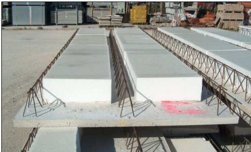
La lastra in c.a. è armata con una rete metallica  $\varnothing 5$  con maglie di 22 per 25 cm, oltre alla armatura normale di tre tralicci metallici (per ogni modulo da 120 cm) consistenti in 2  $\varnothing 5$  inferiori ed un  $\varnothing 7$  superiore.
